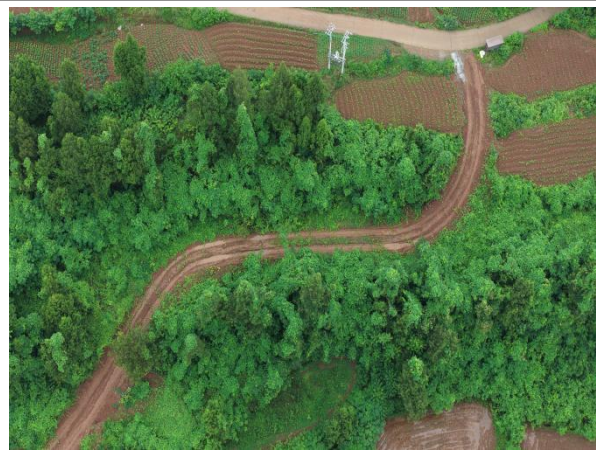
28#塔位机械化施工道路
