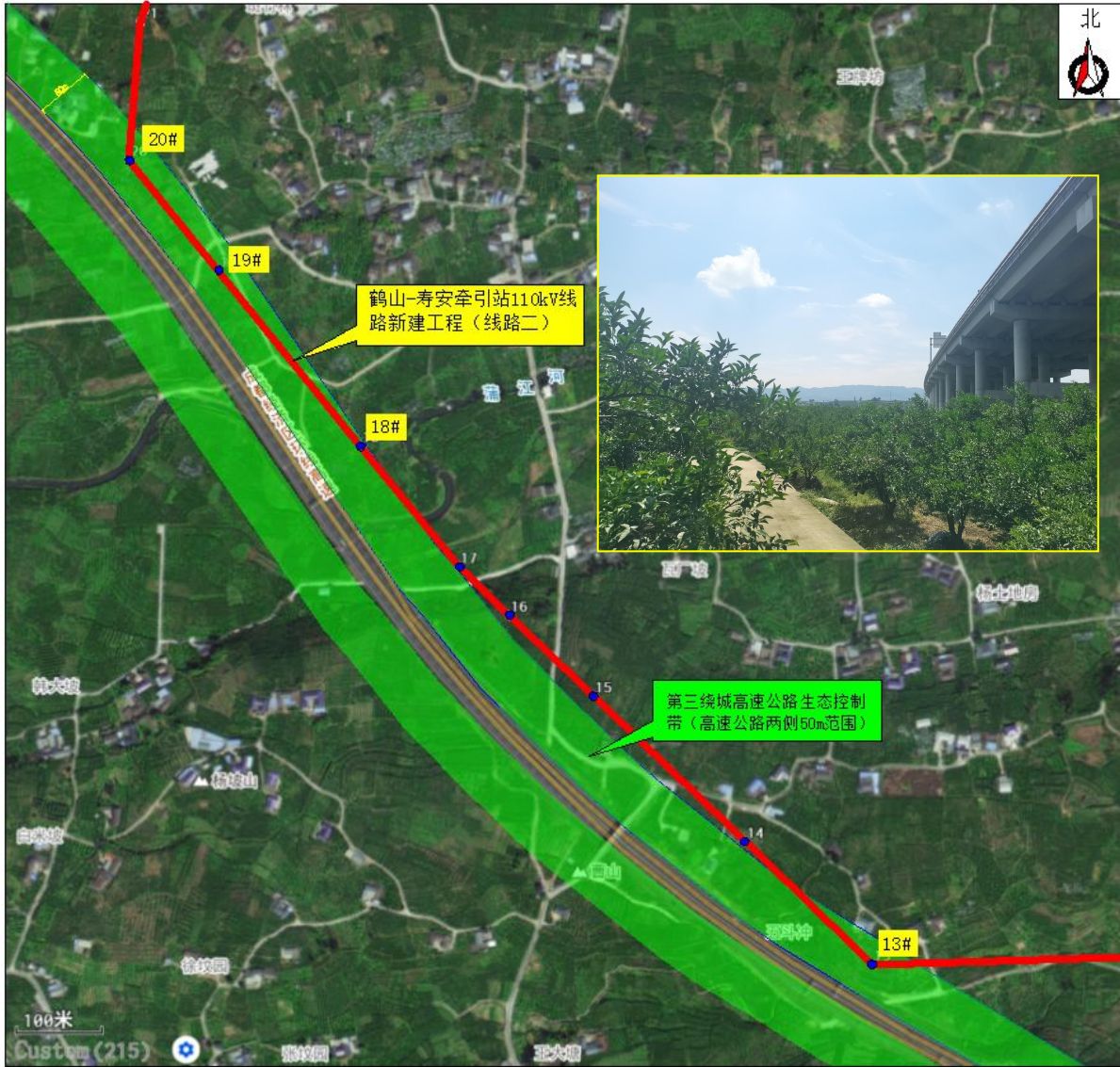
图 3-1 本工程线路二跨越第三绕城高速公路生态控制带
