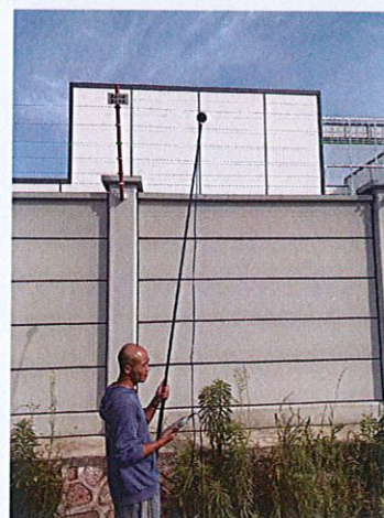
凉风顶 110kV 变电站西北侧站界测点 1 昼间噪 声监测
