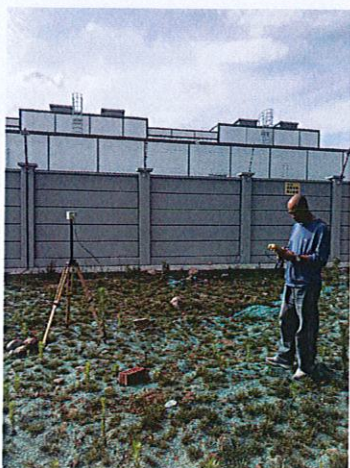
凉风顶 110kV 变电站东南侧站界电磁环境监测
