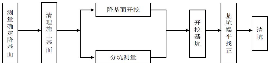
图1土石方施工流程图
