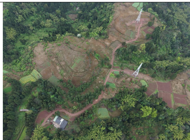
紫竹~石羊N90、龙台~石板 \pi 入石羊N21汽运道路未进行覆土、土地整治及植被恢复
