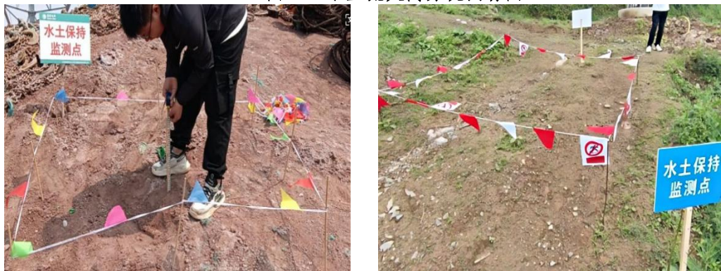
图 3-2 对塔基区布设测钎，定期对测钎进行监测
