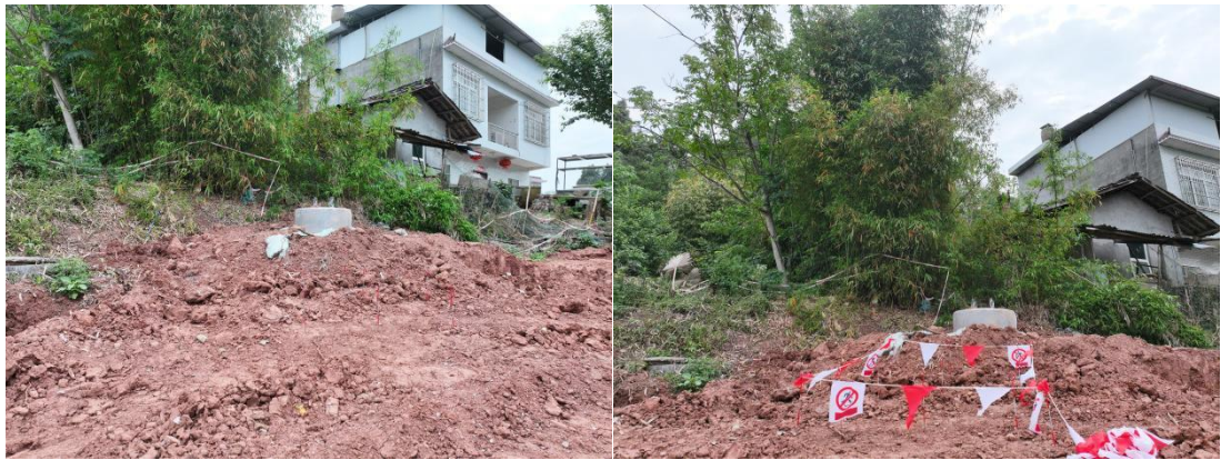
图 3-1、图 3-2 对塔基区布设测钎，定期对测钎进行监测
