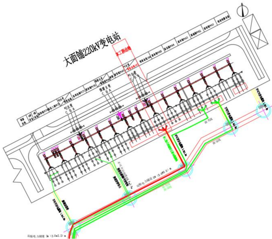
图 2.1-9 大面铺站进出站电缆通道示意图（虚线框为本工程出线间隔）
