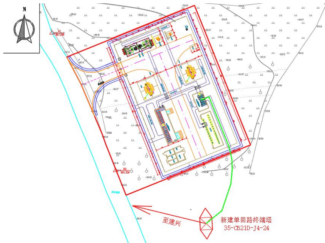
图2.1-3 古楼变电站平面布置
