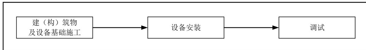
图 3-4 本项目施工工艺流程
