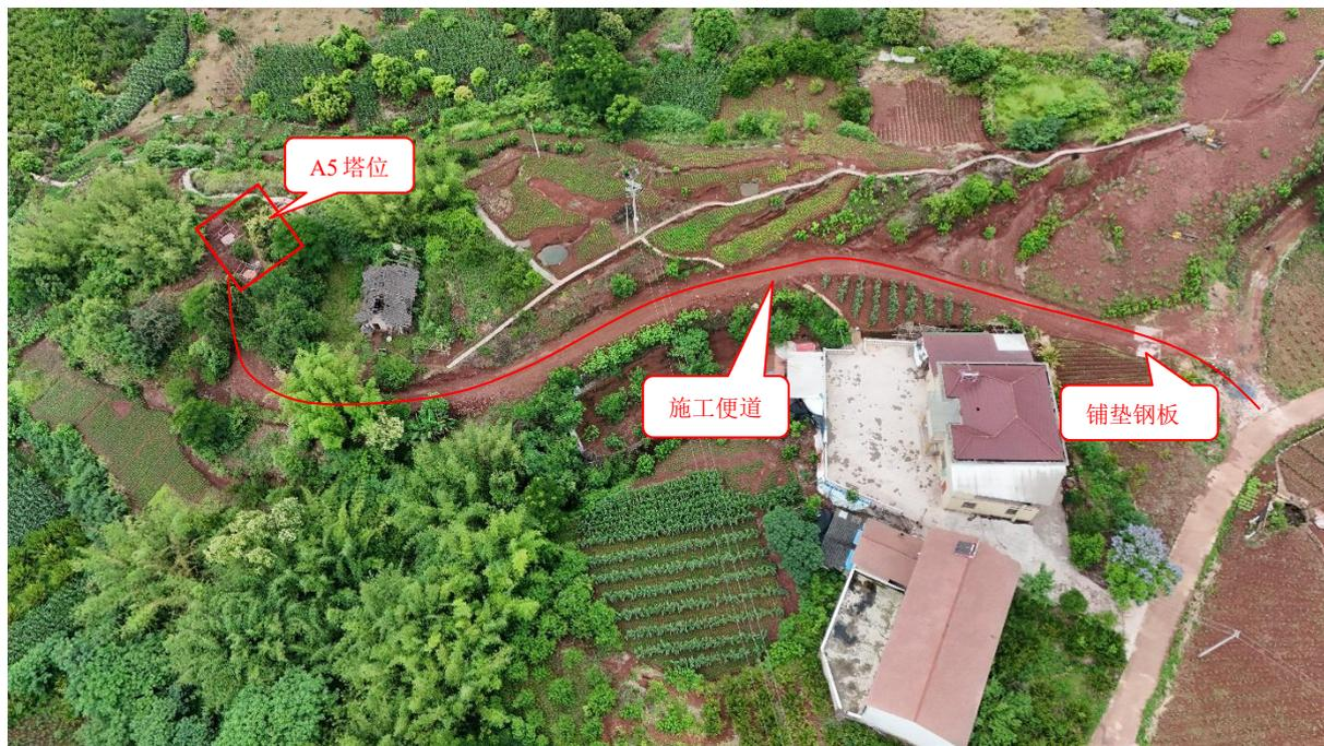
叙府—高县 220kV 线路工程 A5 施工道路基钢板铺垫措施
