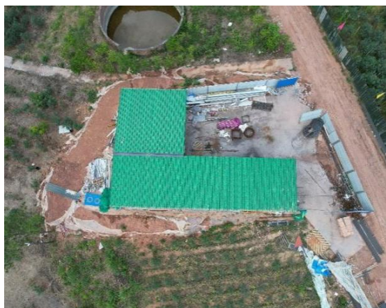
临时堆土场周边缺乏临时拦挡、排水、沉沙措施，且临时苫盖损坏
