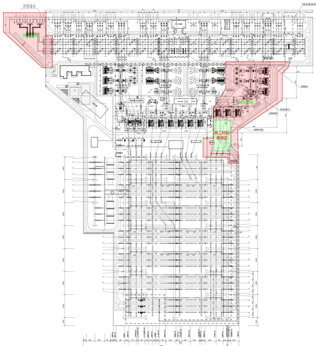
图 3-6 变电站扩建施工场地布置示意图
