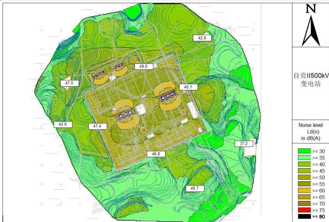
图 6-69 采取专项控制措施后自贡 II500kV 变电站噪声预测（贡献值）等声级线图
