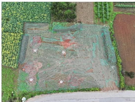
图8-7 塔基区表土堆存保护
