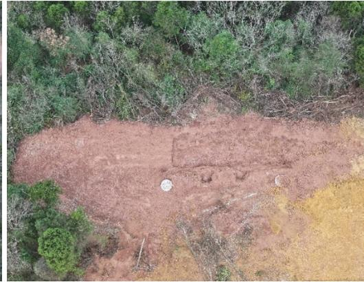
图5-4 现场存在多处坑洞平整不到位
