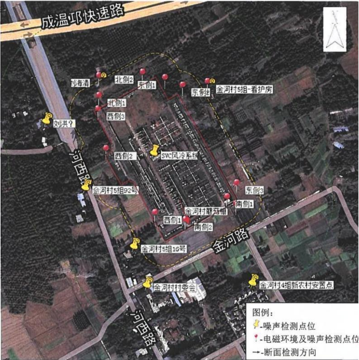
图 6-1 类比变电站的监测布点情况
