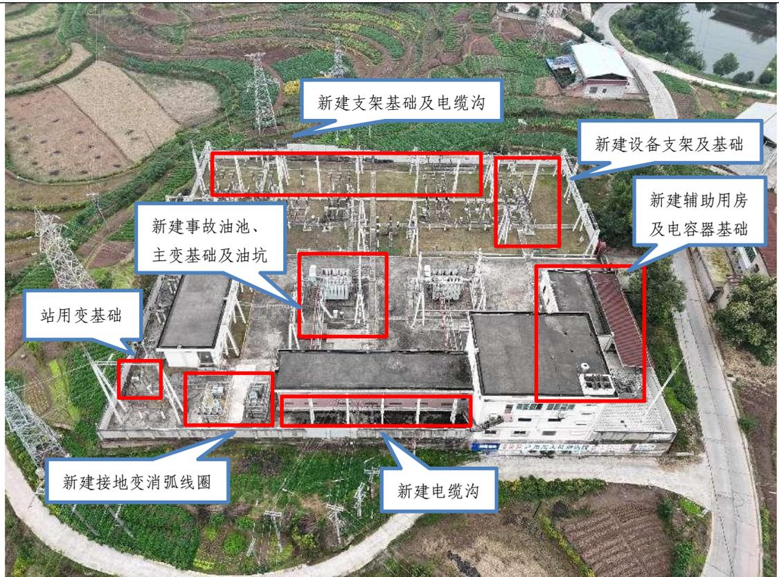
玄淮 110kV 变电站航拍图（红框为本次主要改造区域）
