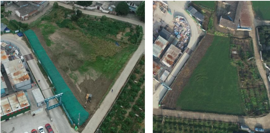
站外临时堆土区已完成土地整治（2024 年 3 季度、4 季度对比图）
