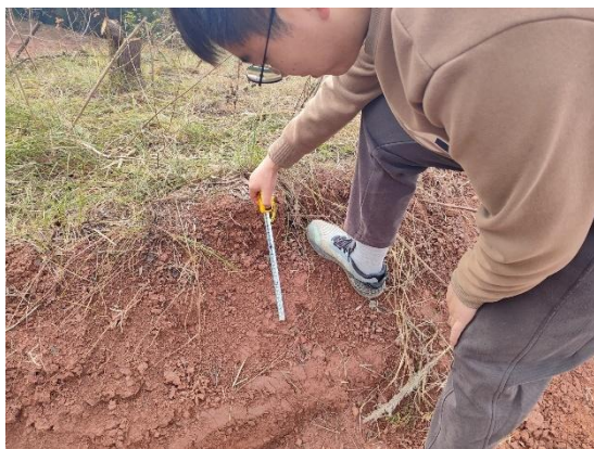
图3-12 对表土厚度进行量测
