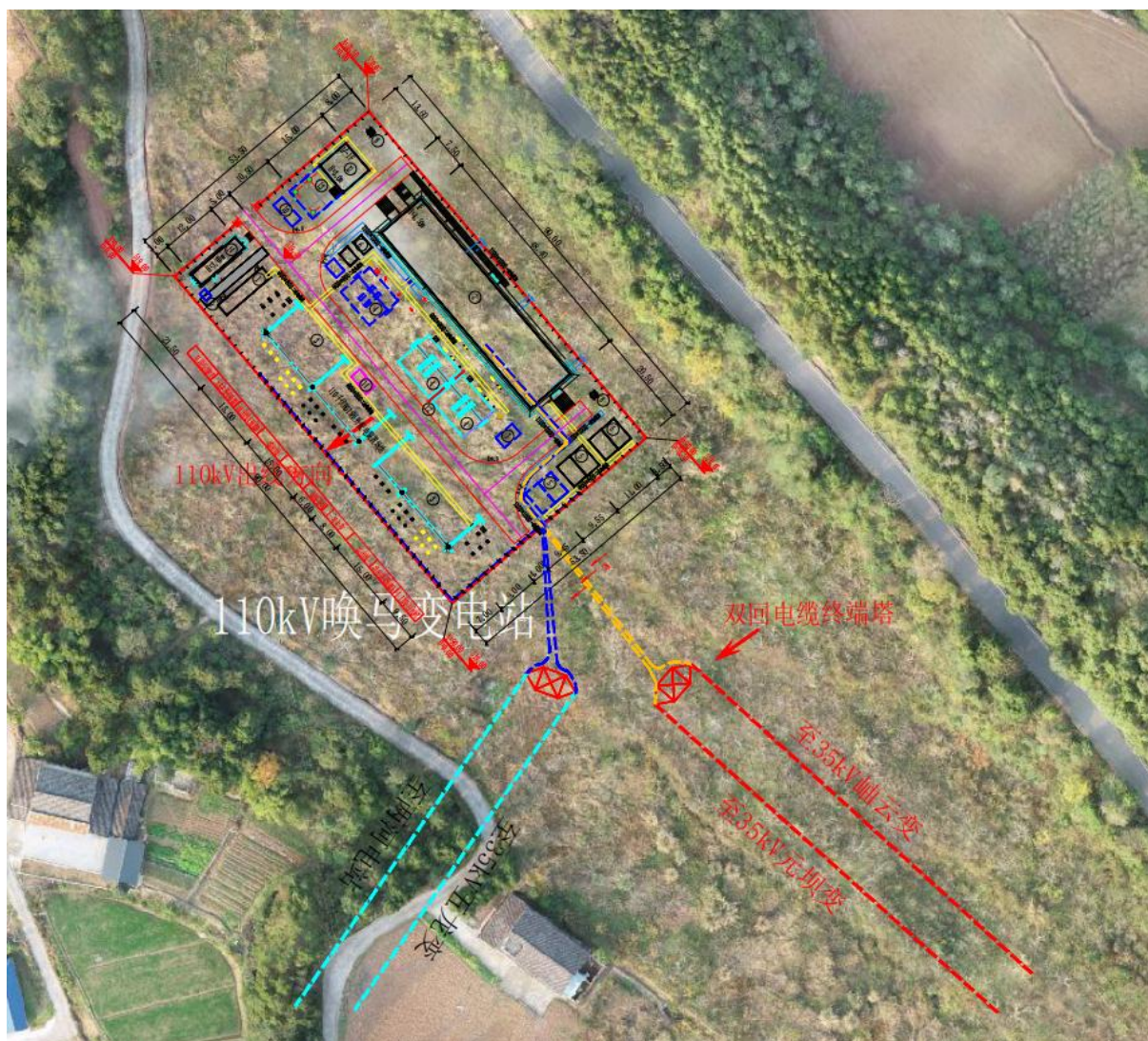
图 2.1-1 110kV 唤马变电站进出线平面示意图
