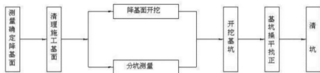
图2-3 土石方施工流程图
