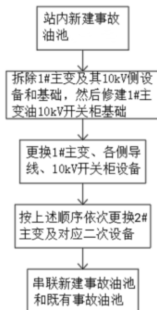
图3 本项目变电站增容扩建施工工艺
