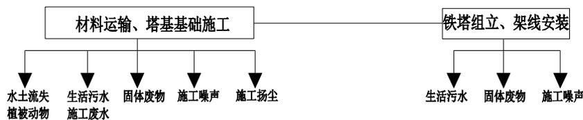
图 13 架空段施工工艺及产污环节图
