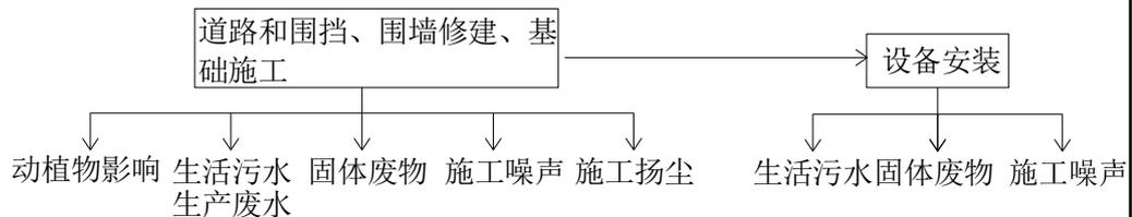
图 13 变电站施工工艺及产污环节图
