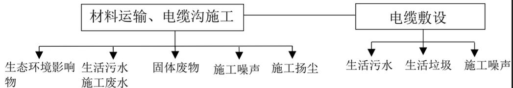
图 12 电缆段施工工艺及产污环节图
