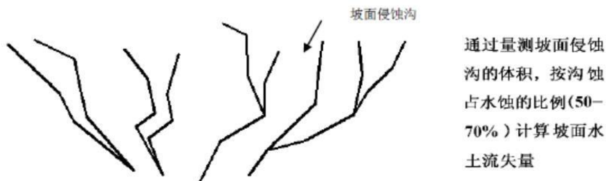
图 2-3 侵蚀沟观测场示意图
