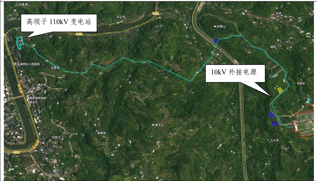
图 1-23 10kV 外接电源布置示意图
