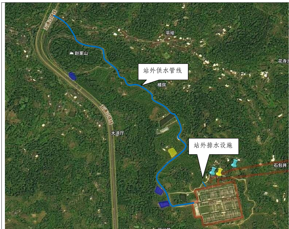
图 1-20 站外供水管线布置示意图
