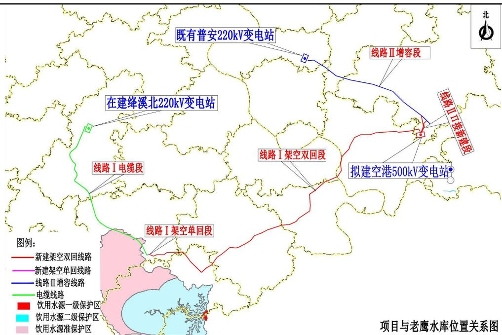
图 17 本项目线路 I 电缆段与老鹰水库位置关系图
