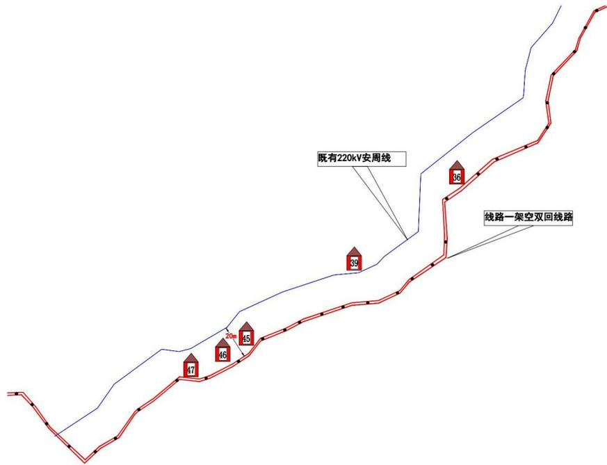
图 9 线路 I 架空双回段与 220kV 安周线并行段敏感目标示意图
