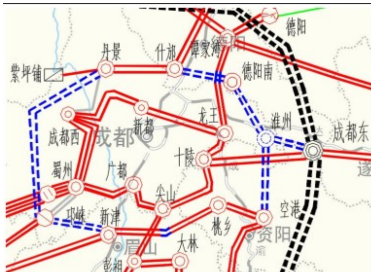
图 3-1 四川电网 500kV 环网
