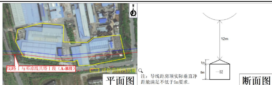
图2 4#环境敏感目标被跨越房屋平、断面图
