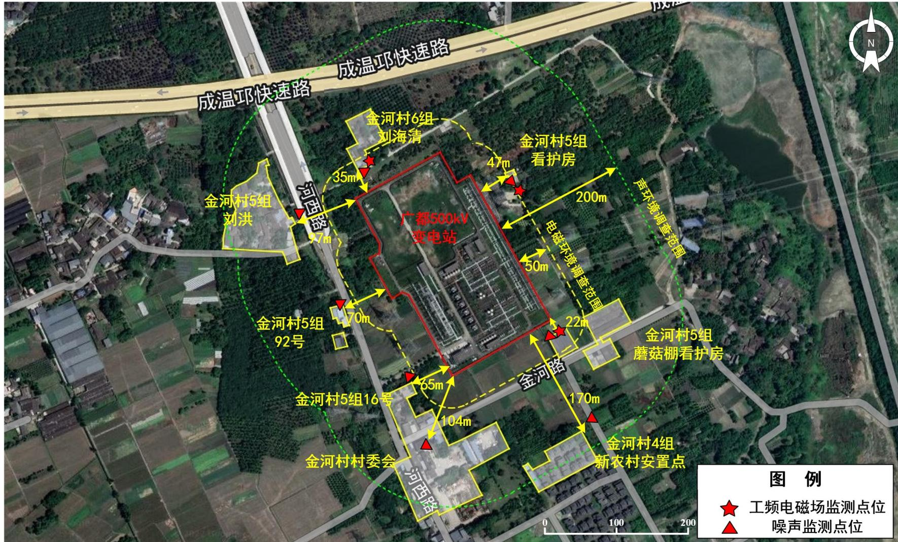
图 7.2-1 广都 500kV 变电站环境敏感目标监测布点示意图
