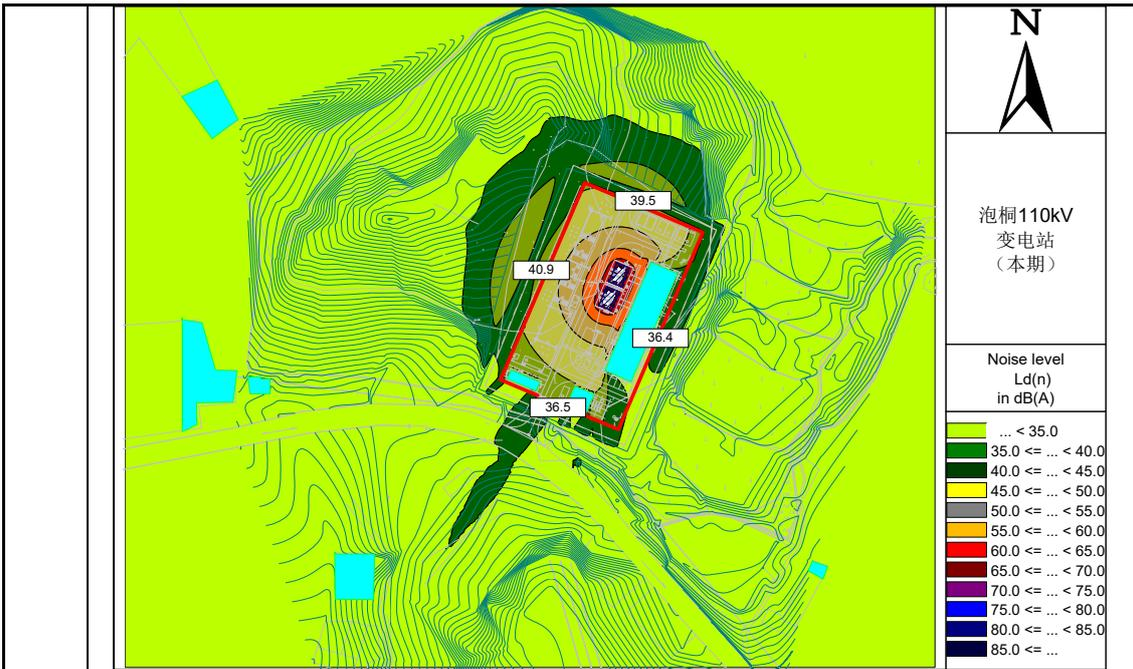
图 12 新建泡桐变电站本期噪声预测等声级线图
