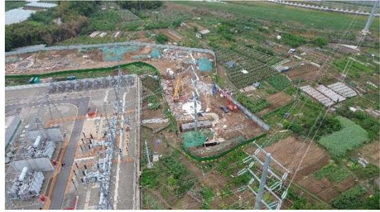
红砂220kv变电站未设置碎石压盖、电缆通道堆土土袋挡墙设置不到位
