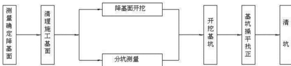
图 2-5 土石方施工流程图
