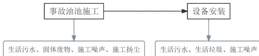
图 5 施工工艺及产污环节图
