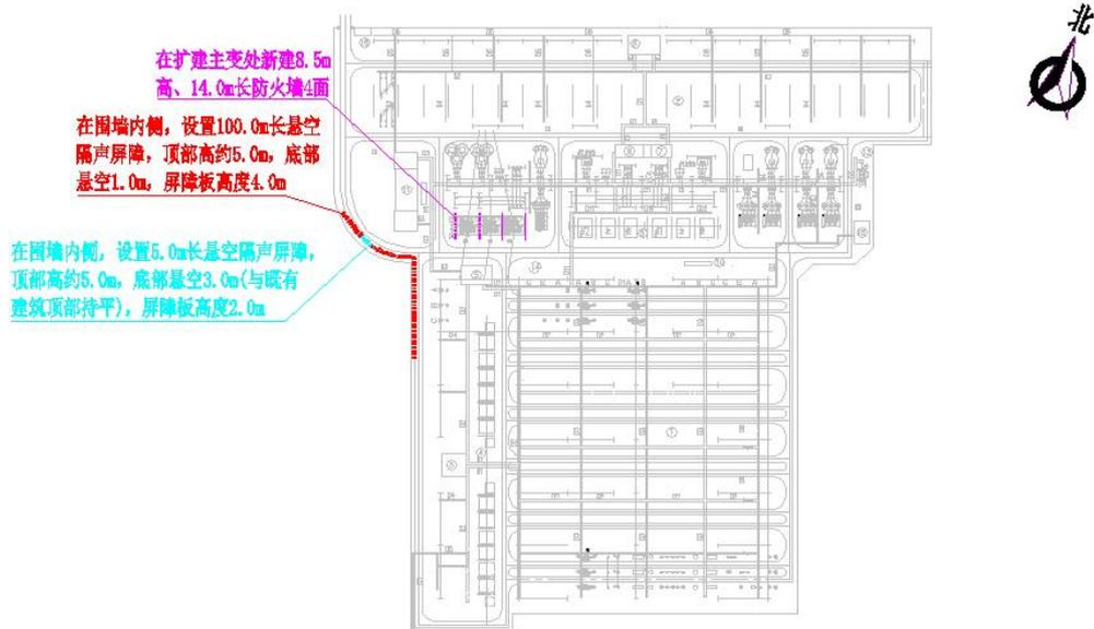
图 6-11 本工程噪声控制方案示意图
