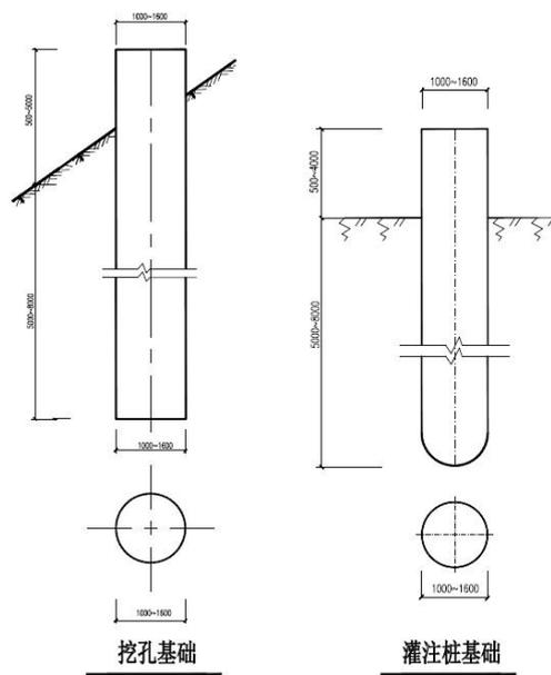
图 3-3 基础型式图
