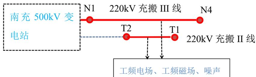
图 3-11 本项目 220kV 输电线路运营期工艺流程及产污环节图
