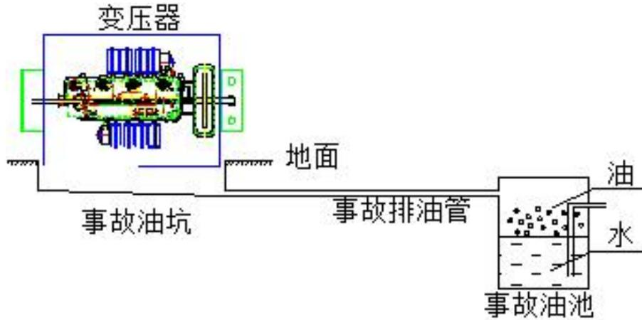
图 6-14 事故油池处理流程示意图
