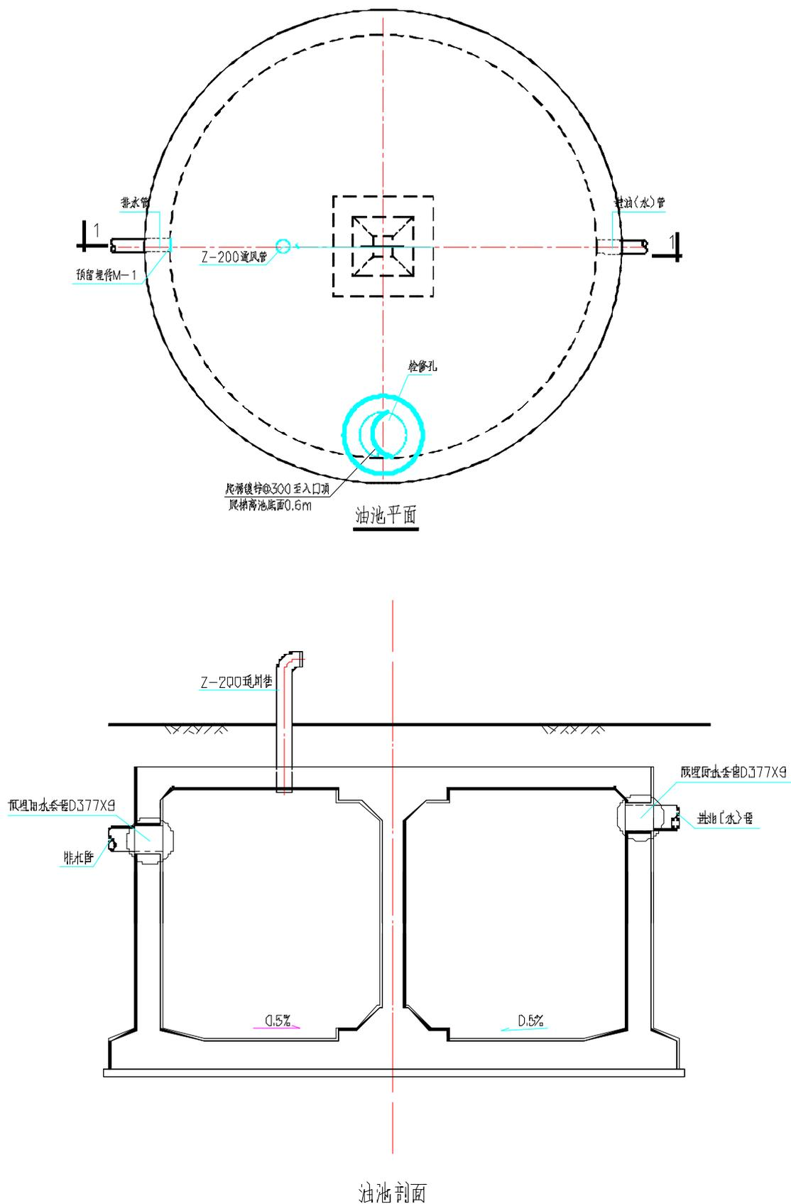
图 6-13 事故油池结构示意图
