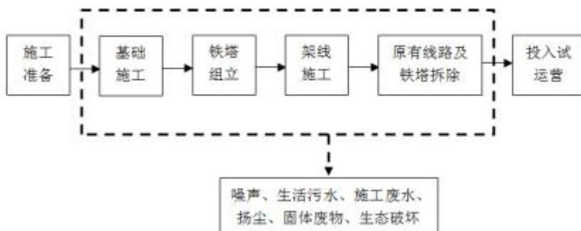
图 3-9 线路施工期工艺流程及产污环境图
