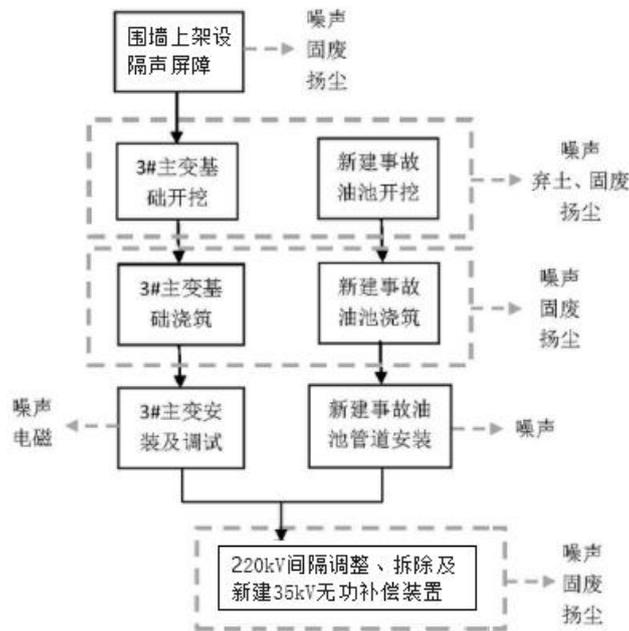
图 3-8 施工工艺流程及产污位置图
