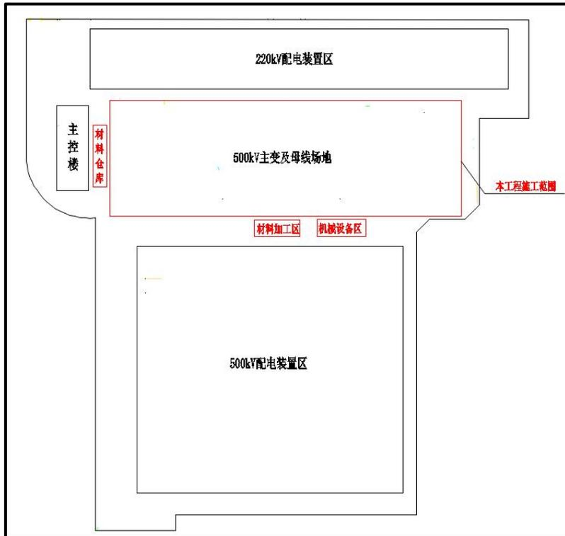
图 3-4 施工场地布置示意图
