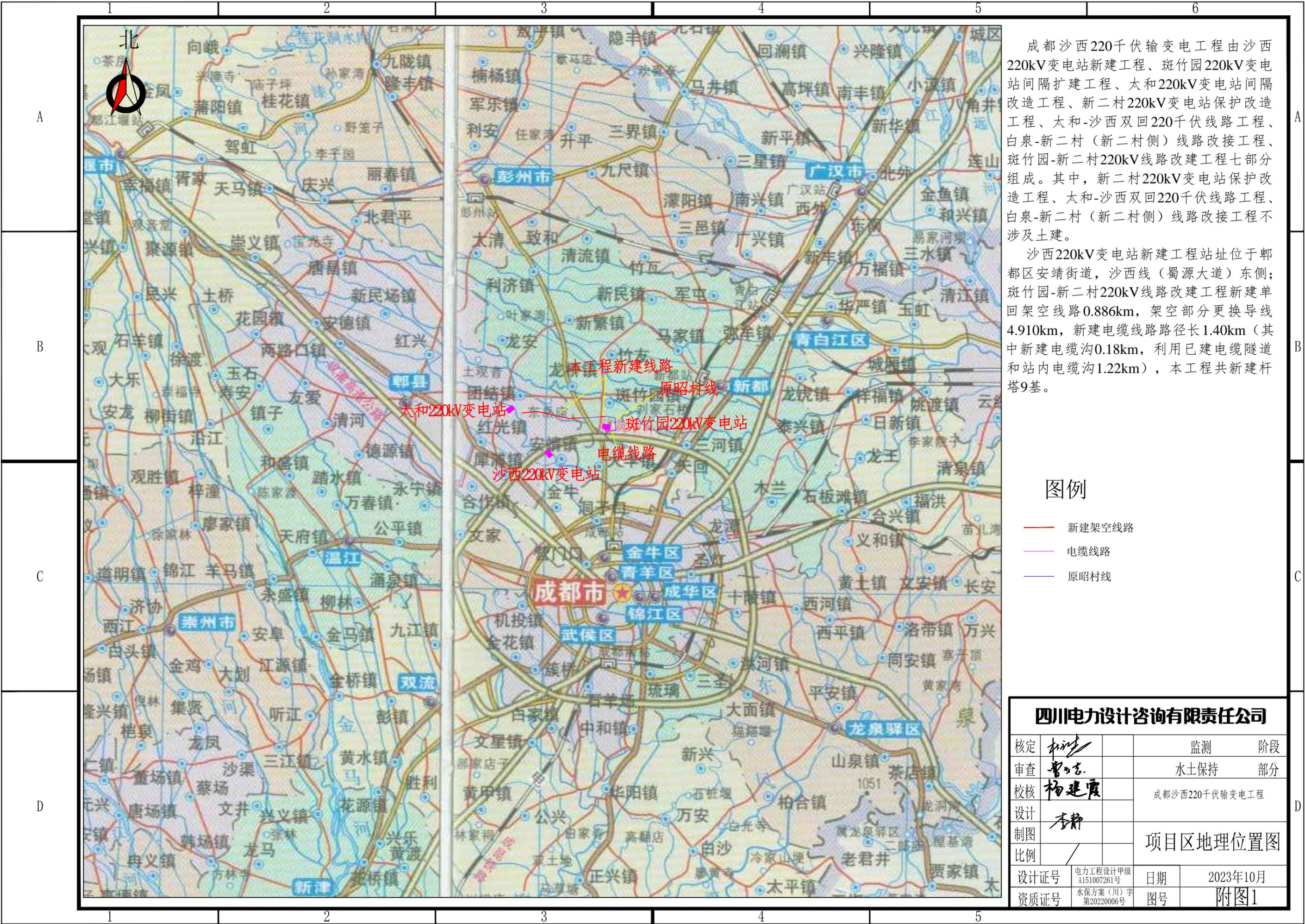
成都沙西220千伏输变电工程由沙西220kV变电站新建工程、斑竹园220kV变电站间隔扩建工程、太和220kV变电站间隔改造工程、新二村220kV变电站保护改造工程、太和-沙西双回220千伏线路工程、斑竹园-新二村220kV线路改建工程七部分组成。其中，新二村220kV变电站保护改造工程、太和-沙西双回220千伏线路工程、斑竹园-新二村220kV线路改建工程不涉及土建。
