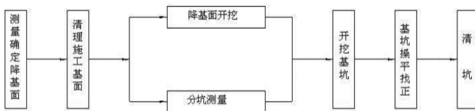
图 2-3 土石方施工流程图
