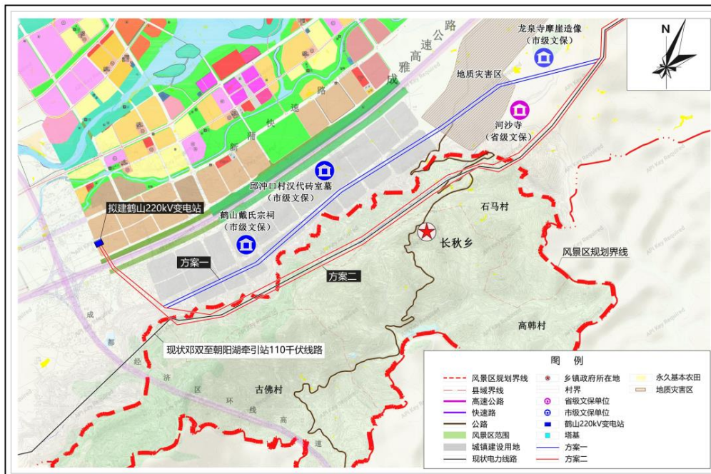
图 2-4 本工程穿越朝阳湖省级风景名胜区长秋山片区路径方案比选示意图 1) 方案一
