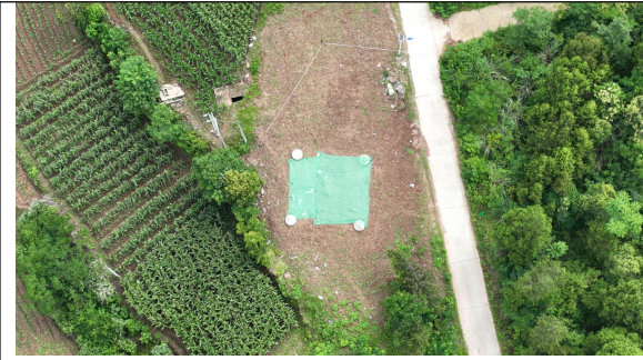
阆北-马鞍牵引站（N2）-基础浇筑后平整、密目网遮盖
