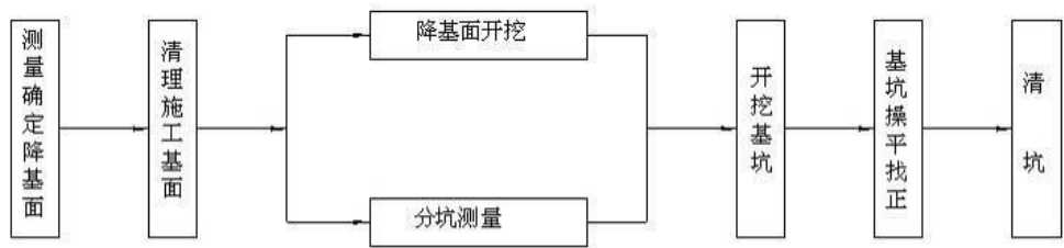
图1 土石方施工流程图
