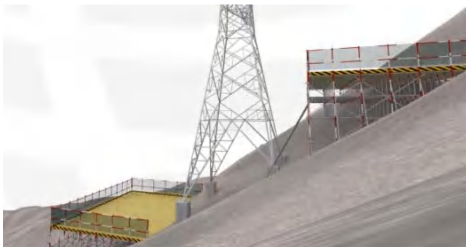
图 3-2b 钢管平台架搭设示意模型图
