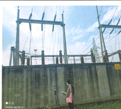
图 4-12 民主 110kV 变电站东侧站界围墙外 5m, 地面 1.5m 噪音监测
