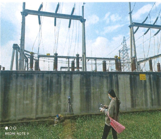
图 4-6 民主 110kV 变电站东侧站界围墙外 5m, 地面 1.5m 电磁监测
