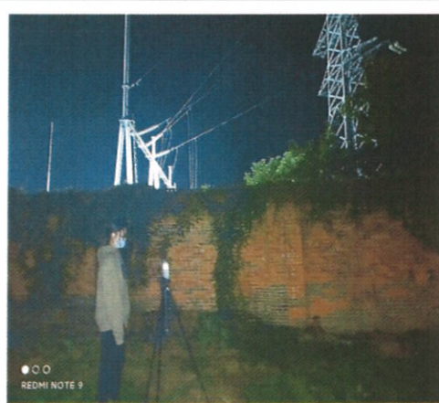
图 4-10 官仓 110kV 变电站东侧站界 2# 监测点围墙外 1m, 地面 1.5m 夜间噪音监测
