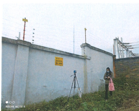
图 4-1 官仓 110kV 变电站西侧站界 2#监测点 围墙外 1m, 地面 1.5m 电磁监测
