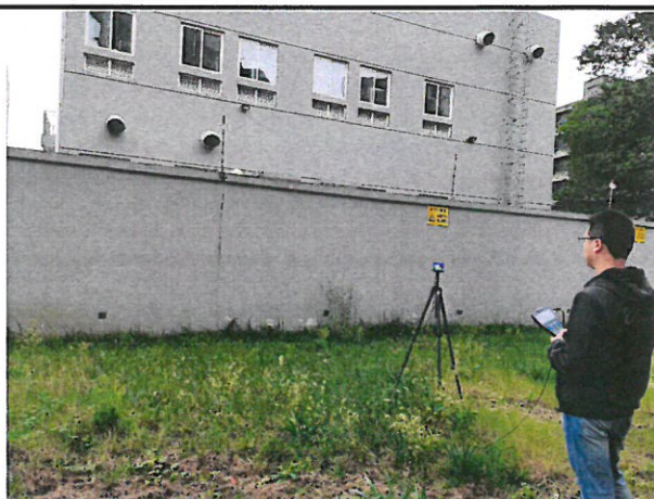
府青路 110kV 变电站西侧站界电磁监测
