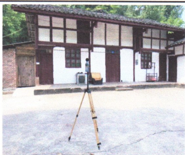
图 2-1 巴中草池 220 千伏变电站东侧史学兴 家噪声昼间监测
