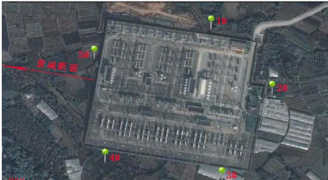
图 6-1 桃乡 500kV 变电站竣工环保验收站界电磁环境监测点位示意图
