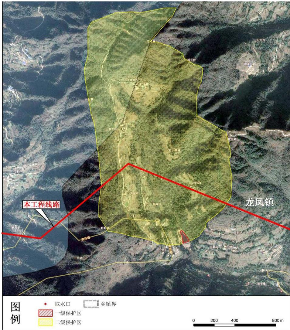
图 7.5 线路与龙凤镇地下水型水源地相对位置关系示意图
