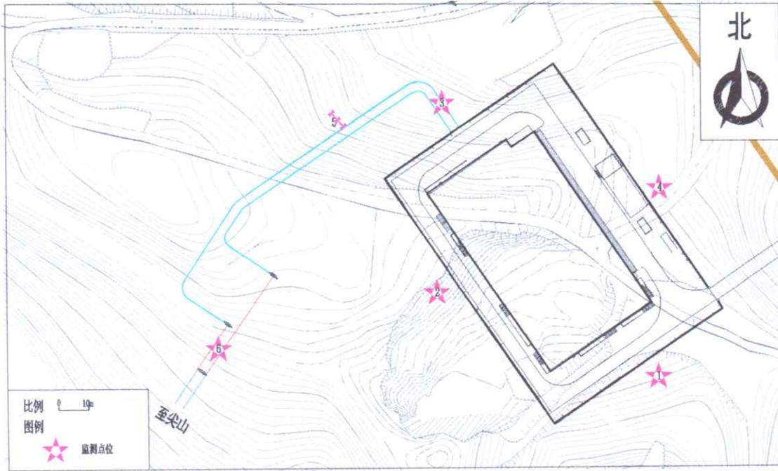
图1 成都秦皇寺220千伏输变电工程检测布点示意图
